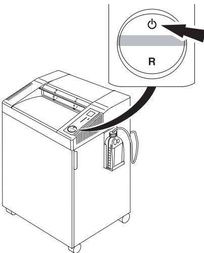
**DE** Autom. Standby - Abschaltung nach 15 Minuten. Maschine kann jederzeit durch Drücken des Schalters ausgeschaltet werden. Grüne Kontrollleuchte erlischt. Danach verbraucht die Maschine keinen Strom mehr. Innerhalb dieser 15 Minuten verbraucht der Aktenvernichter folgende Wh Energie:
