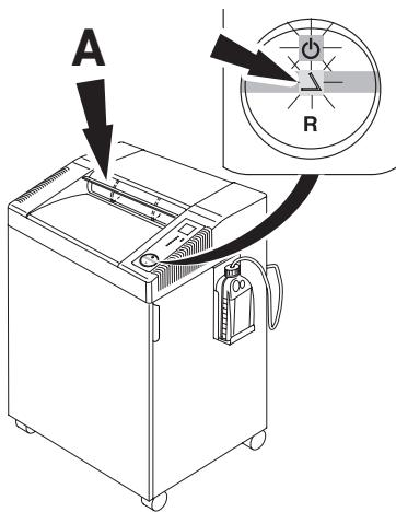
**NL** Automatische stop als de veiligheidsklep (A) geopend wordt (Symbolen  $\triangle$  en  $\odot$  knipperen afwisselend.)
