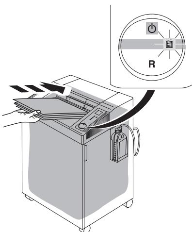
**DE** Automatischer Stopp bei vollem Auffangsack.
