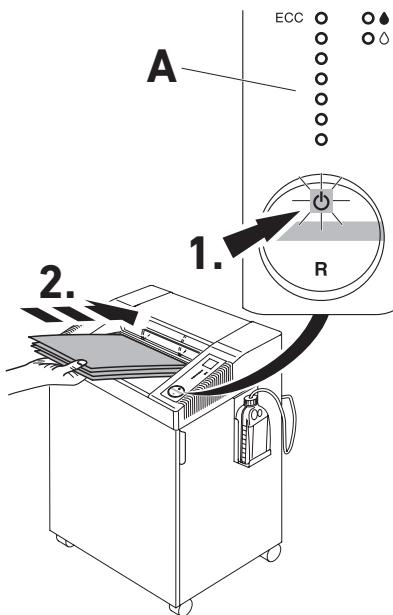
**SV** Tryck på knappen (1.). Grönt ljus visar "klar att använda" startar automatiskt när papper förs in (2.). Automatiskt "standby"-läge som stängs av efter 15 minuter. Maskinen kan stängas av genom att in knappen. Grön diod när kontrollampen är avstängd. Då drar inte maskinen någon mer ström.
