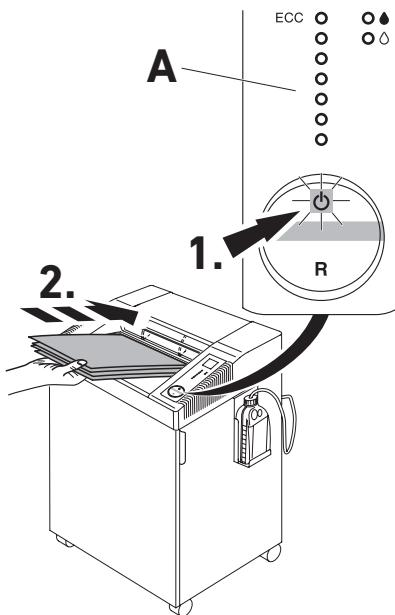
**NL** Schakelaar indrukken (1.) : groen licht gaat aan, machine is bedrijfsklaar. Start automatisch zodra papier wordt ingevoerd (2.). Automatische standby schakelt naar 15 minuten uit.
